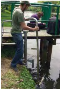
Einsetzen eines Spektrometers an der Stadtspre Installation of spectrometer at urban section of River Spree
